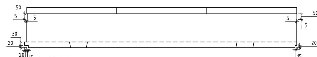
SNITT B-B 1-LØPS KABELKANAL (370) BxH=370x356 (UTVENDIG M/LOKK) 1:10
